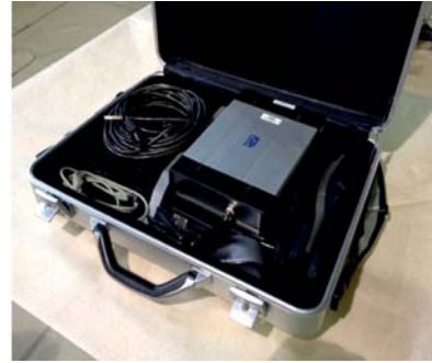
Рис. 1. Спектрометр SDMF-1206PRO в малогабаритном кейсе.
